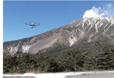
図1. 御嶽山平成26年噴火の際には、急遽、ドローンに火山ガス分析装置を搭載し、人間の手では不可能な、危険な火口でのガス観測に成功しました。
