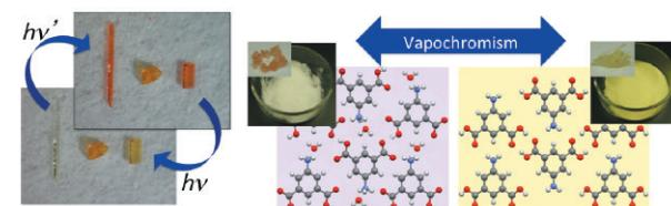
図3. 光照射により色変化を示す有機フォトクロミック結晶（サリチリデンアニリン誘導体）の多形結晶による機能制御（左図）、環境制御（ガス）により色変化を示す有機ベイボクロミック結晶の結晶構造変化（右図）。
