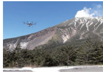
図1. 御嶽山平成26年噴火の際には、急速、ドローンに火山ガス分析装置を搭載し、人間の手では不可能な、危険な火口でのガス観測に成功しました。
