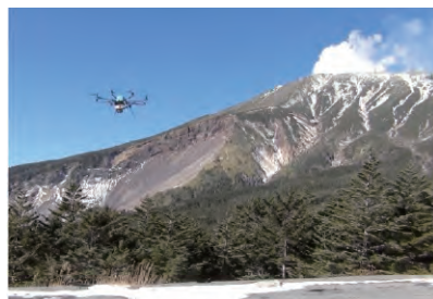
図1. 御嶽山平成26年噴火の際には、急遽、ドローンに火山ガス分析装置を搭載し、人間の手では不可能な、危険な火口でのガス観測に成功しました。
