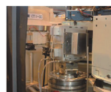
図2 中性子回折計HERMES高温測定システム
